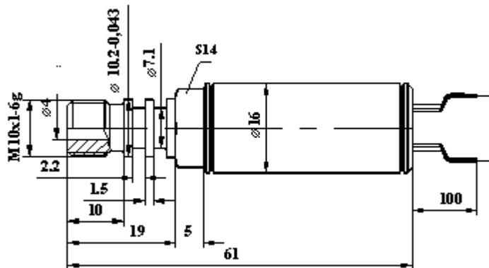
Преобразователь с верхним пределом диапазона термокомпенсации до плюс 200 °С
