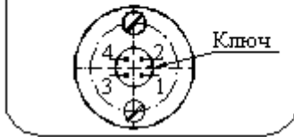
Расположение контактов разъема РСГ 4ТВ
