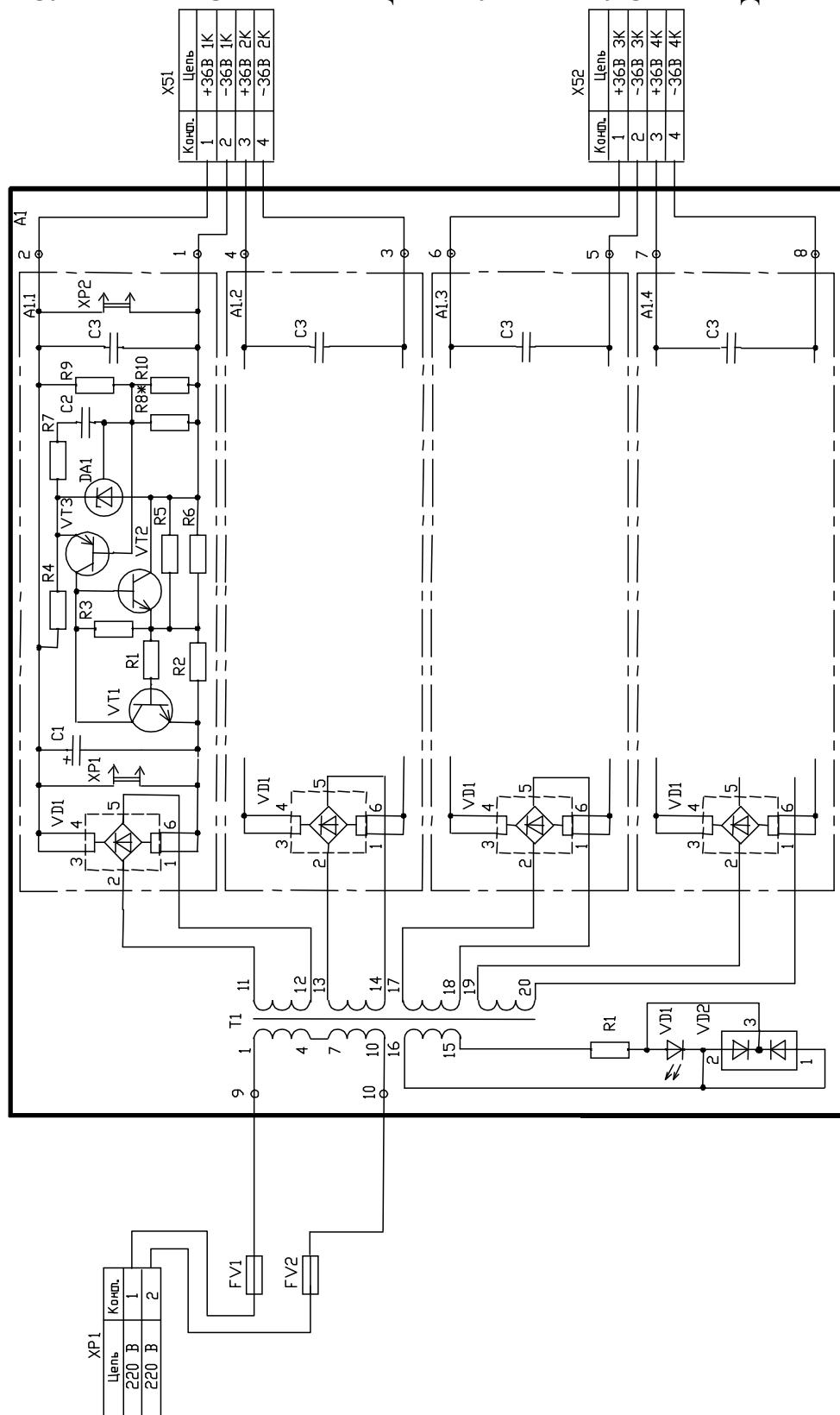
Примечание. В схеме двухканального блока МИДА-БП-104Р-2к отсутствуют элементы, входящие в состав функциональных групп А1.3, А1.4, и разъем XS2.
